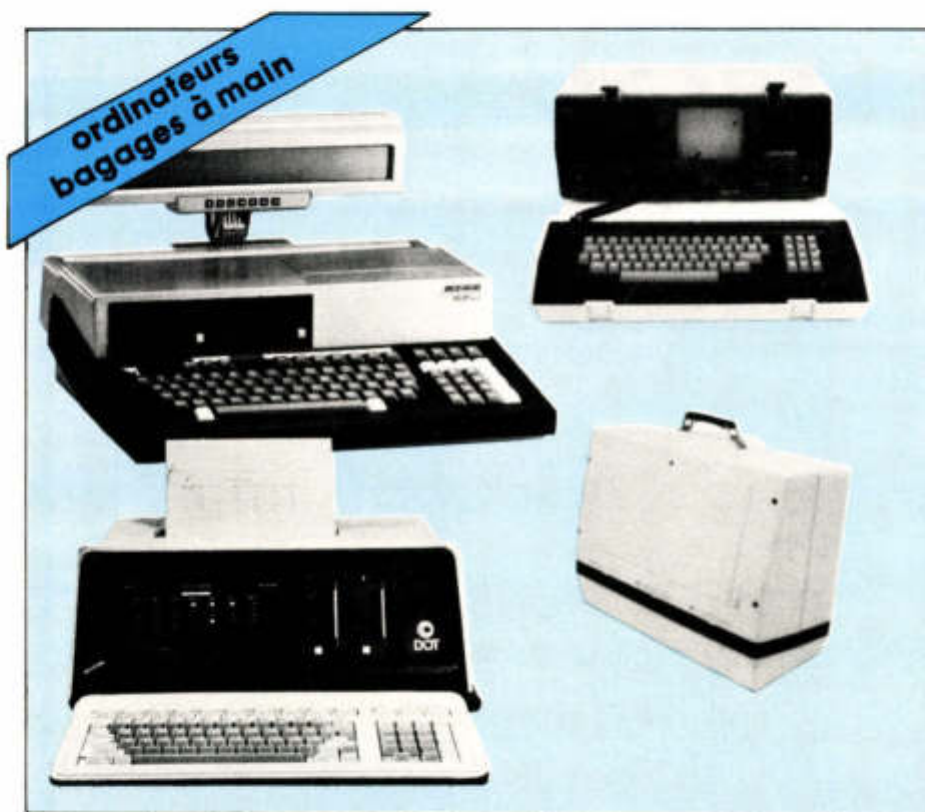
Plus transportables que portables (poids jusqu'à 10 kg), ce sont de vrais ordinateurs de table, avec clavier, écran et unité de disquettes et une importante bibliothèque de logiciels comprise dans le prix de vente (de 10 000 à 30 000 FF).
